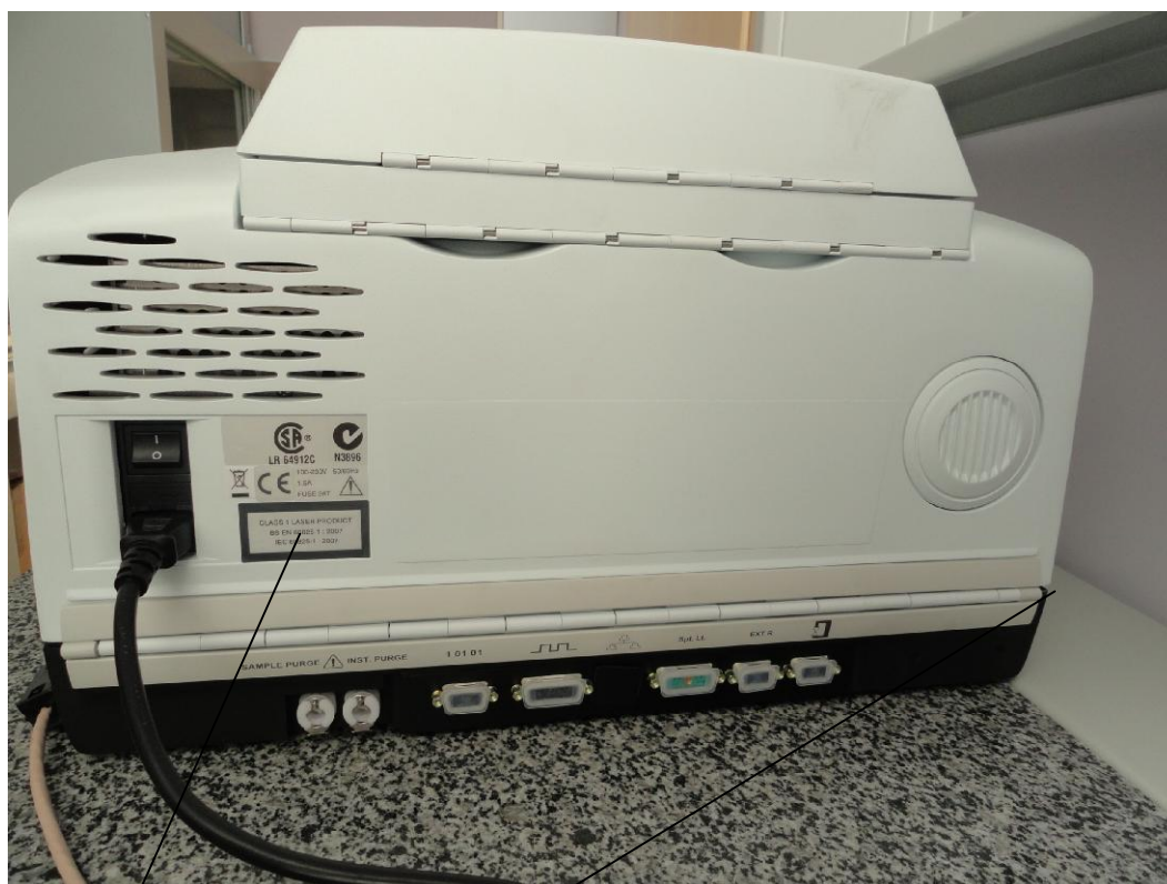
1 2 Рисунок 4 - Фурье-спектрометр инфракрасный Frontier - вид сзади 1 - маркировка ; 2- место пломбирования;
